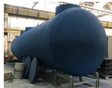
Емкости снабжены подводными и отводящими патрубками, горловинами, лестницами обслуживания. Количество, диаметр и расположение горловин и патрубков выполняется в соответствии требованиями заказчика либо с проектным решением.
