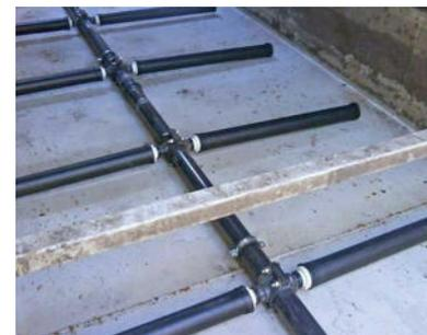
Трубчатый аэратор — это разновидность аэратора с развитой технологией, надежной работой, отличной производительностью и широким применением. Он имеет характеристики низкой потери давления, высокой скорости переноса кислорода и удобной установки. Уникальное расположение массива пор в мембране снижает вероятность разрыва между отверстиями.
