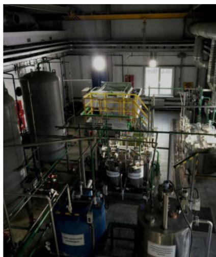
Комплекс очистки промышленных сточных вод на базе флотационных установок. Самарская область
